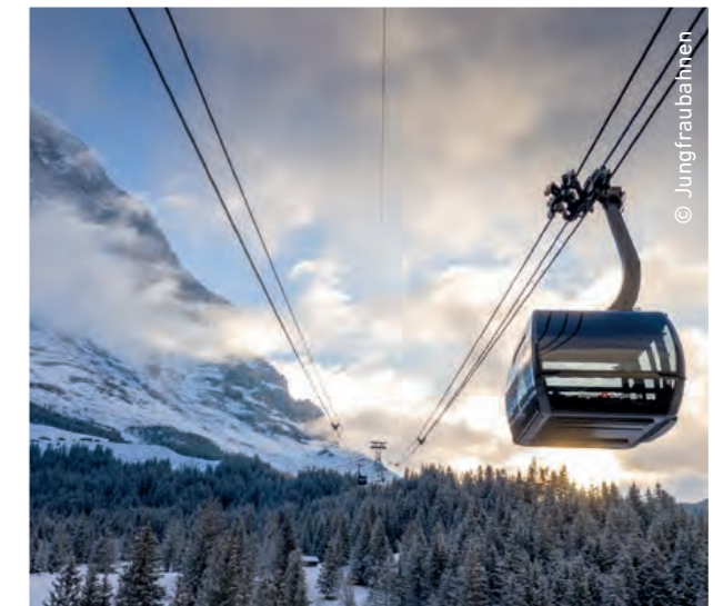
Pro Stunde befördert der «Eiger Express» 2200 Personen in beide Richtungen. Dank schallabsorbierenden Verkleidungen an der Talstation und weiteren Massnahmen werden die Lärmgrenzwerte heute eingehalten.
